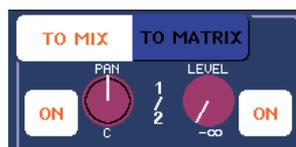
Pour un canal INPUT, le bouton droit règle le niveau d'envoi commun vers les deux bus MIX alors que le bouton gauche spécifie le balayage panoramique entre les deux bus MIX. Tournez le bouton gauche TO MIX SEND LEVEL vers la gauche pour augmenter l'intensité du signal envoyé en direction du bus MIX impair et vers la droite pour renforcer le signal émis vers le bus MIX pair.
