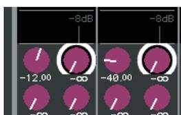
Cette bordure épaisse indique que le paramètre correspondant à ces boutons peut être modifié. Dans ce cas de figure, vous pouvez utiliser les encodeurs multifonction 1-8 pour modifier les valeurs des paramètres des canaux correspondants.
