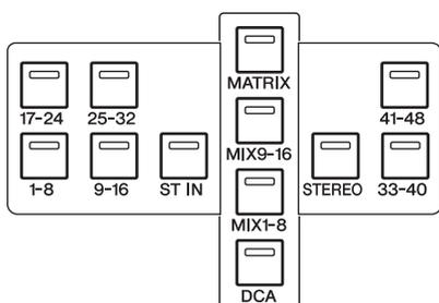
Les touches de navigation de la section NAVIGATION KEYS sélectionnent les huit canaux ou groupes DCA qui seront contrôlés par la section Centralogic. Dans cette section, les touches suivantes correspondent aux canaux d'entrée.
