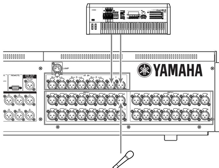
Les prises INPUT 1–32 { 1–48 } servent principalement à brancher des microphones ou des périphériques de niveau ligne mono. Les prises ST IN 1–4 (L/R) servent principalement à brancher des périphériques de niveau ligne stéréo.
