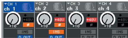
4 Pendant que vous utilisez le micro ou l'instrument, utilisez les encodeurs multifonctions 1-8 de la section Centralogic pour ajuster le gain HA de chaque canal.
