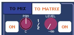
Pour un canal INPUT, le bouton droit règle le niveau d'envoi commun vers les deux bus MATRIX alors que le bouton gauche spécifie le balayage panoramique entre les deux bus MATRIX. Tournez le bouton gauche TO MATRIX SEND LEVEL vers la gauche pour augmenter l'intensité du signal envoyé sur le bus MATRIX impair et vers la droite pour renforcer le signal émis en direction du bus MATRIX pair.
