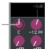
Ces boutons ajustent le panoramique entre deux bus paramétrés sur stéréo. (Avec un canal stéréo, ils ajustent la balance du volume gauche/droite des signaux envoyés aux deux bus.)
