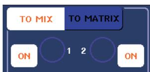
Si le bus MIX de destination de l'envoi est de type VARI, le bouton TO MIX SEND LEVEL s'affichera sous une couleur identique à celle de l'encodeur correspondant dans la section SELECTED CHANNEL. Dans ce cas, vous pourrez utiliser l'encodeur correspondant de la section SELECTED CHANNEL pour régler le niveau d'envoi.
