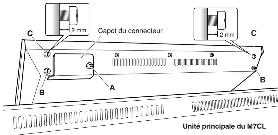
4. Placez les orifices **D** du système d'attache du MBM7CL au-dessus des vis **C** du M7CL (deux emplacements, à gauche et à droite).
