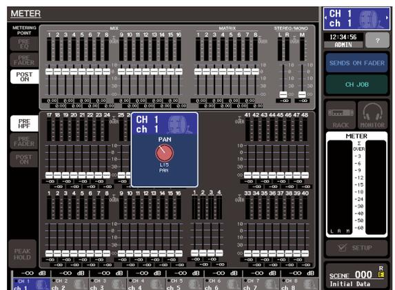
**3 Utilisez les encodeurs de la section SELECTED CHANNEL et les touches de l'écran SELECTED CHANNEL VIEW pour modifier les paramètres du canal sélectionné.**
