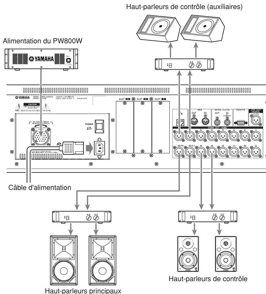
Vous pouvez assigner les signaux de sortie des canaux de sortie (MIX, MATRIX, STEREO (L/R), MONO (C)), les signaux d'écoute (canal MONITOR OUT L/R/C) et les signaux de sortie directs des canaux INPUT 1–32 { 1–48 } aux prises OMNI OUT 1–16.
