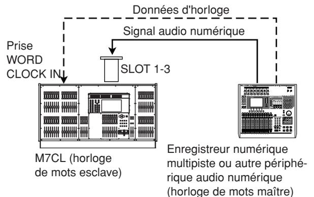
Dans les deux cas, vous devez utiliser la procédure suivante pour indiquer la source de l'horloge de mots qui sera utilisée par la M7CL.
