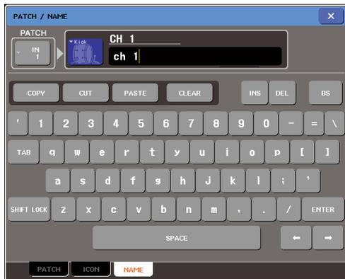
**7 Utilisez les touches [SEL] pour basculer entre les canaux d'entrée, et spécifiez l'icône ou le nom de canal pour d'autres canaux de la même façon.**
