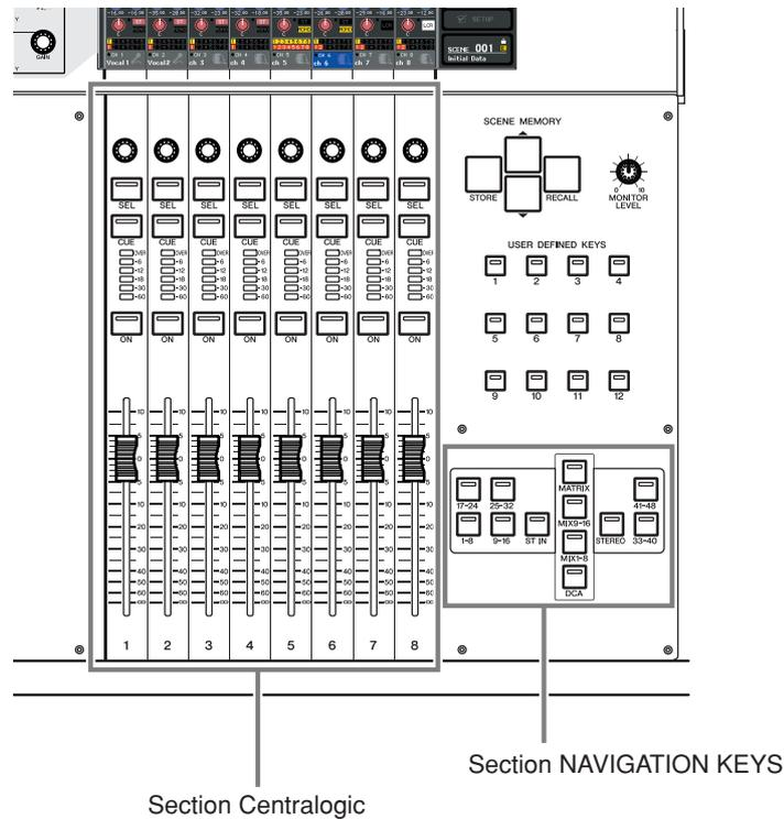
Lorsque vous appuyez sur l'une des touches de navigation de la section NAVIGATION KEYS, les canaux/groupes DCA correspondant à cette touche sont assignés à la section Centralogic et peuvent être contrôlés à l'aide des faders, des touches [ON] et des touches [CUE] de la section Centralogic.
