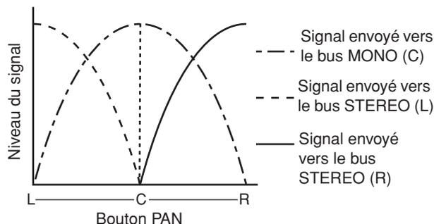
L'utilisation du bouton TO ST BALANCE d'un canal ST IN change le niveau des signaux envoyés depuis les canaux ST IN L/R vers les bus STEREO (L/R) et MONO (C), tel qu'illustré dans le schéma suivant.
