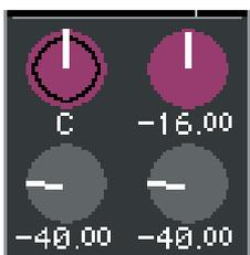
La plupart des boutons sont liés aux opérations des encodeurs de la section SELECTED CHANNEL ou des encodeurs multi-fonctions. La valeur actuelle s'affiche également sous forme numérique directement au-dessous du bouton concerné.
