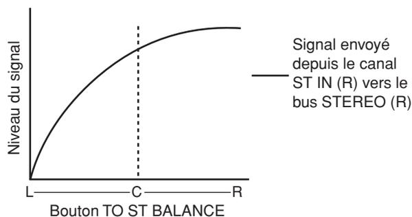
Lorsque le bouton CSR est réglé sur 100 %, la manipulation du bouton INPUT TO ST PAN modifie le niveau des signaux envoyés vers les bus STEREO (L/R) et MONO (C), tel qu'illustré dans le schéma suivant.
