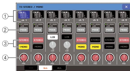
Vous pouvez contrôler ici les réglages d'activation/désactivation de panoramique/balance du signal envoyé depuis les canaux d'entrée vers les bus STEREO (L/R) et MONO (C), par groupe de huit canaux.
