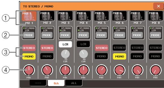
Vous pouvez contrôler ici les réglages d'activation/désactivation de panoramique/balance du signal envoyé depuis les canaux MIX vers les bus STEREO (L/R) et MONO (C), par groupe de huit canaux.
