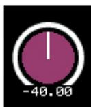
Lorsque vous utilisez les encodeurs multi-fonctions pour manipuler un bouton, la ligne indiquant le réglage de ce dernier s'allonge et celle entourant sa circonférence s'atténue ; ceci identifie clairement le bouton que vous êtes en train d'actionner. Un cadre apparaît également autour de la valeur numérique concernée.
