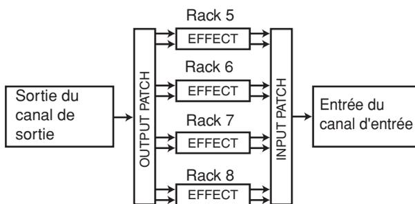
Alternativement, vous pouvez attribuer l'entrée et la sortie de l'effet interne à l'entrée/sortie d'insertion du canal choisi (excepté pour un canal ST IN), cela afin que l'effet soit inséré dans ce canal.
