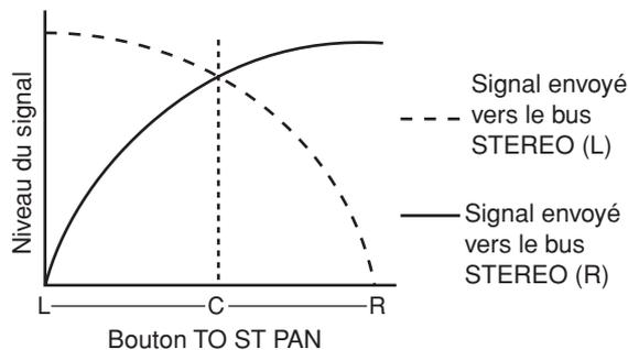
L'utilisation du bouton TO ST BALANCE d'un canal ST IN change le niveau des signaux envoyés depuis les canaux ST IN L/R vers les bus STEREO (L/R) et MONO (C), tel qu'illustré dans le schéma suivant. Dans ce cas, le bouton TO ST PAN fonctionne comme un bouton BALANCE traditionnel, et aucun signal n'est envoyé vers le bus MONO (C).
