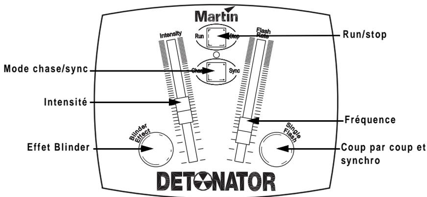
Le contrôleur optionnel " Detonator " propose les fonctions suivantes :
