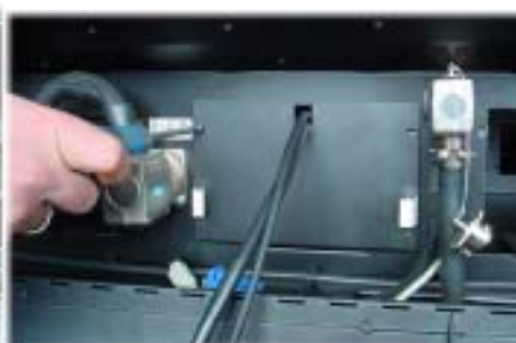
Fixer fermement le Kit de connexion en remettant les 4 vis prévues à cet effet. Deux câbles sortent de ce module afin de connecter un PC externe.
