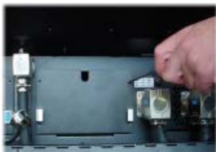
Enlever les 4 vis de maintien du kit de connexion externe.
