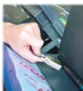
Connecter le câble SUB-D 9 pins sur le port série de l'ordinateur externe.
