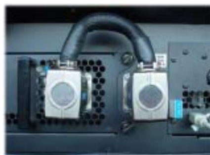
La sortie du rack d'alimentation est connectée à la surface de control à l'aide de connecteurs Jaeger 17Pts.
