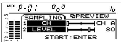
4. Tournez [PARAM 1] pour sélectionner le canal d'entrée (INPUT CHANNEL).
