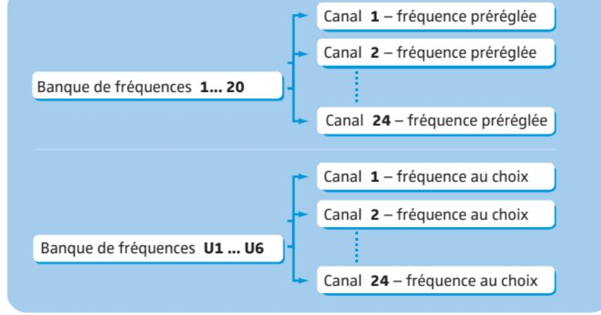
Chacun des canaux dans les banques de fréquences « 1 » à « 20 » est assigné une fréquence fixe et préréglée (preset) en usine.
