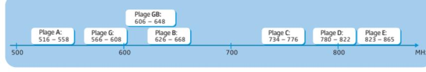
Chaque plage de fréquence (A–E, G, GB) offre 26 banques de fréquences avec respectivement jusqu'à 24 canaux :
