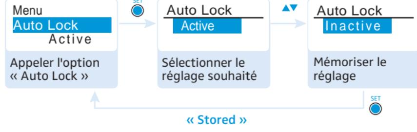
Le verrouillage des touches évite que l'émetteur de poche soit désactivé involontairement pendant le fonctionnement ou que des modifications soient effectuées. Le symbole d'activation du verrouillage des touches ⑤
