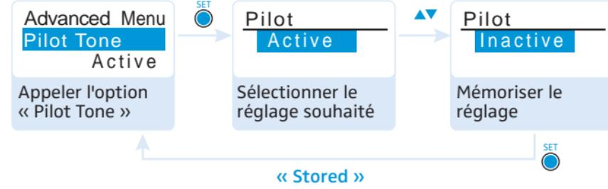
La fréquence du signal pilote est inaudible. Cette fréquence est émise par l'émetteur de poche et analysée par le récepteur.
