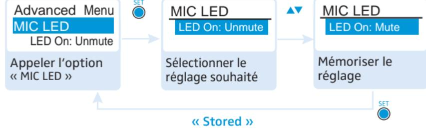
L'option « **MIC LED** » vous permet de régler le comportement de la LED **STATUS** du commutateur « mute » externe RMS 1 (accessoire optionnel) en fonction des réglages effectués dans l'option « **Mute Mode** » et de l'état du signal radio.
