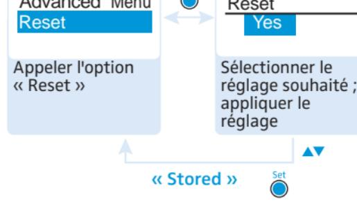
Lors de l'annulation des réglages effectués dans le menu de commande, seuls les réglages du signal pilote et des banques de fréquences « U1 » à « U6 » sont conservés. Pour une vue d'ensemble des réglages d'usine, veuillez vous référer au supplément de fréquences joint.
