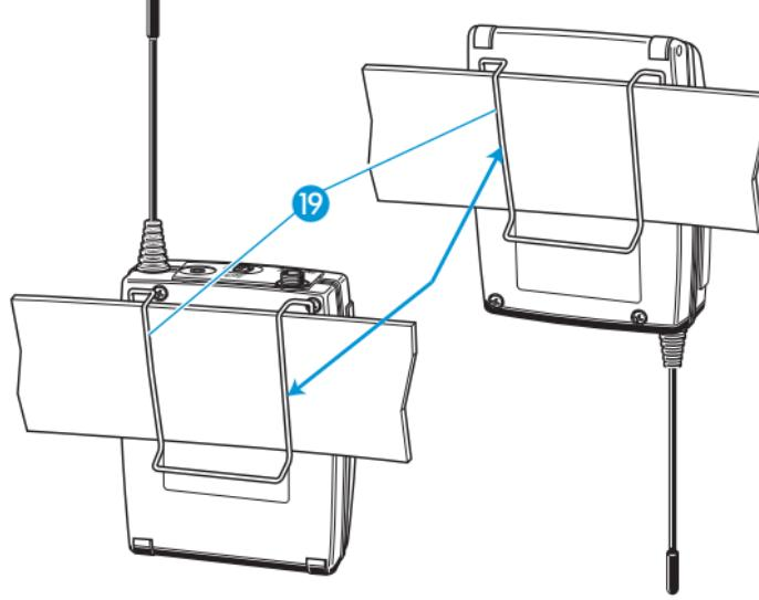
Le clip est détachable afin que vous puissiez fixer l'émetteur de poche avec l'antenne pointant vers le bas. Pour ce faire, retirez le clip ceinture 19 de ses points de fixation et remettez-le en place après l'avoir tourné de 180°.
