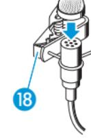
Le micro cravate ME 2 a une directivité omnidirectionnelle. Il n'est donc pas nécessaire de le positionner avec une grande précision.
