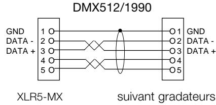
Pour plus de sécurité de fonctionnement, la sortie DMX512/1990 de ce produit a été protégée par une isolation galvanique. L'isolation a été testée pour résister à du 500 V dc, afin d'éviter les problèmes inhérents aux circuits de terre ou de transférer les basses tensions parfois présentes sur certains signaux aux commandes ou autres connecteurs de signaux accessibles à l'utilisateur.
