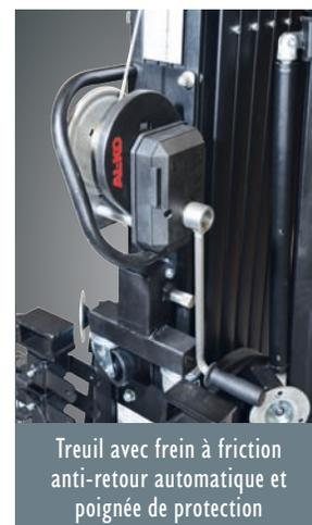
Treuil avec frein à friction anti-retour automatique et poignée de protection
