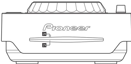
28 Trou d'insertion de la broche d'éjection forcée du disque (la page 16)
