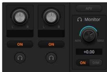
La molette de volume et les boutons du moniteur permettent de régler des niveaux audio de manière indépendante et d'effectuer un contrôle solo du signal de sortie audio.
