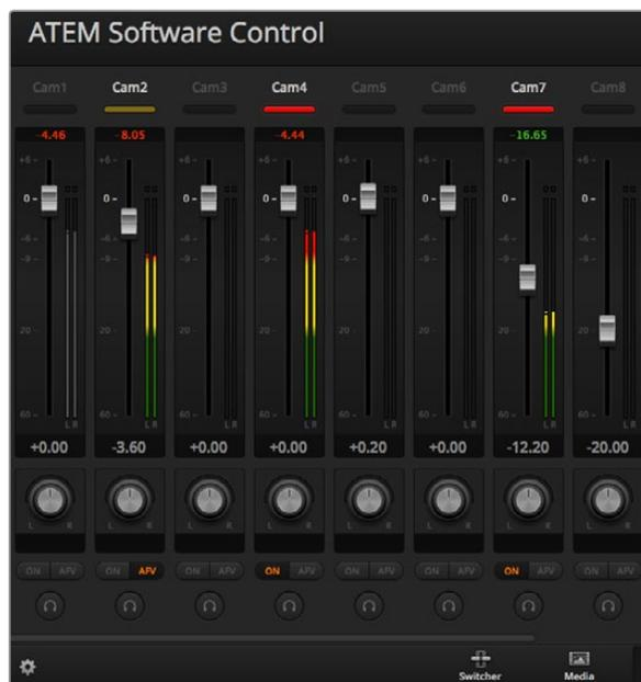
La console de mixage audio affiche des voyants tally pour toutes les sources audio qui sont actuellement à l'antenne ou lorsque la fonction AFV est sélectionnée. Elle comporte également les niveaux audio, la balance audio et des boutons permettant de sélectionner l'audio qui doit être utilisée.
