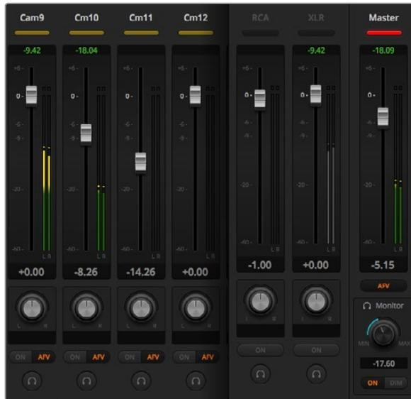
Étape 4 : Essayez de faire glisser les potentiomètres de gain de bas en haut sur votre surface de contrôle hardware et vérifiez que les potentiomètres de la console de mixage audio indiquent une augmentation et une réduction correspondante dans le logiciel sur votre écran d'ordinateur.
