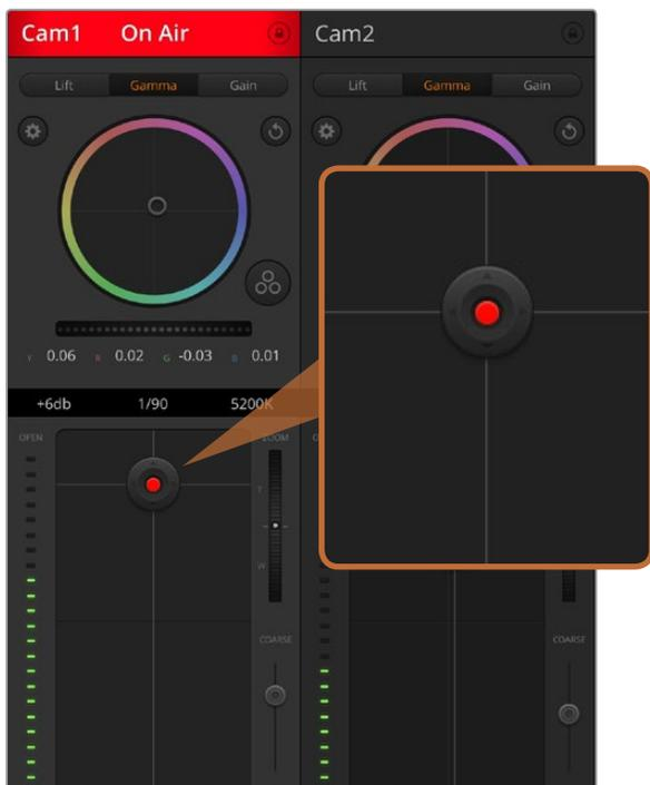
Le contrôle de l'iris/niveau de noir s'allume en rouge lorsque la caméra est à l'antenne.
