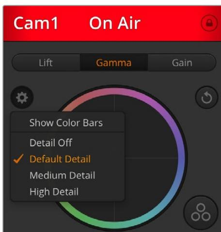
Le bouton relatif aux paramètres de la caméra vous permet d'activer et de désactiver la mire de barres couleurs et d'ajuster la netteté d'image des Blackmagic Studio Cameras connectées au mélangeur.
