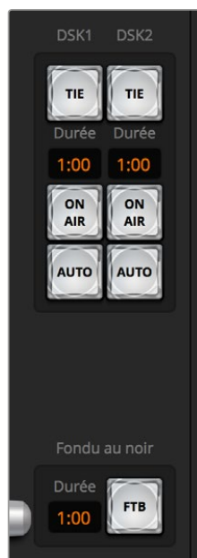
Incrustation en aval et fondu au noir
