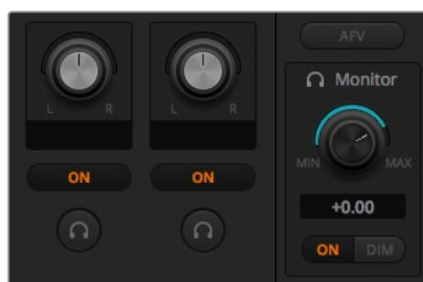
La molette de volume et les boutons du moniteur permettent de régler des niveaux audio indépendants et d'effectuer un contrôle solo du signal de sortie audio.
