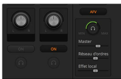
Des commandes audio supplémentaires sont disponibles pour le monitoring audio sur casque lorsque vous utilisez l'ATEM Television Studio HD
